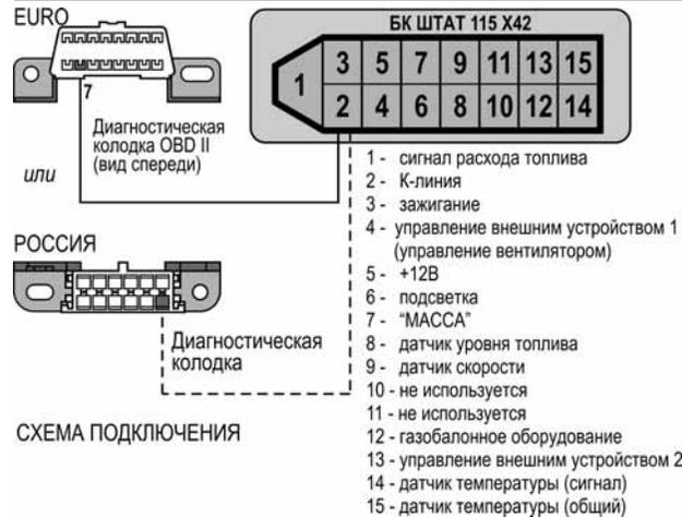
Рис. 3 Схема подключения
